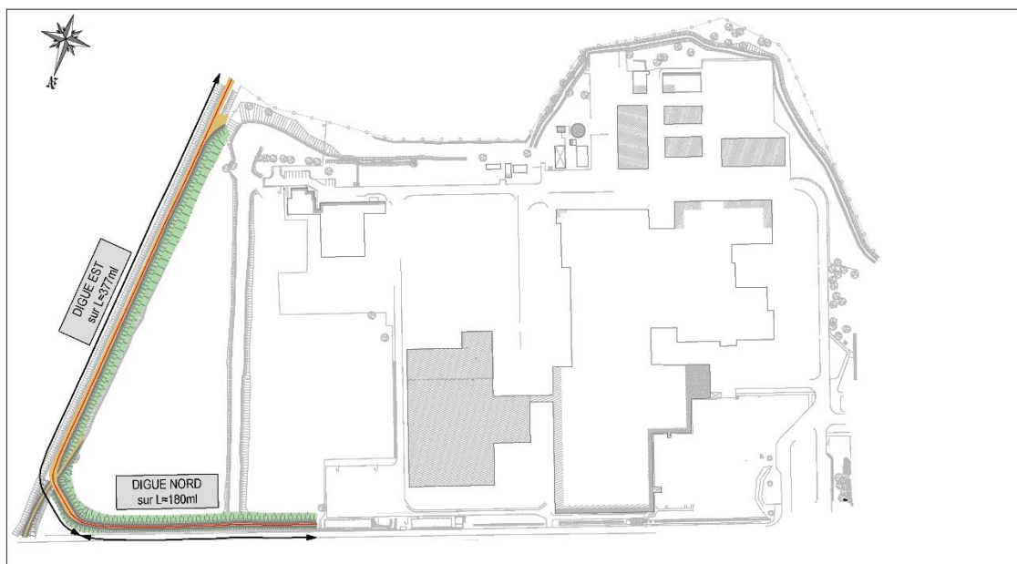
Figure 5-18 : Emplacement des digues de l'ARC à réaliser
