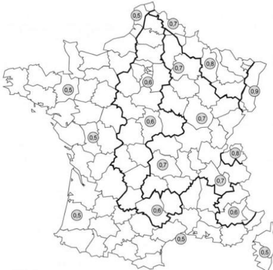
Figure 5-19 : Profondeur hors-gel des fondations.
